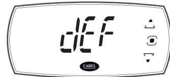
6. Appuyer sur flèche VERS LE BAS jusqu'à trouver la catégorie de paramètres dEF (=dégivrage)
