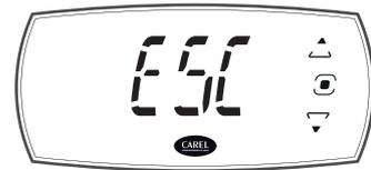
9. Appuyer sur UP/DOWN pour sélectionner ESC, puis appuyer sur PRG pour revenir aux catégories de paramètres
