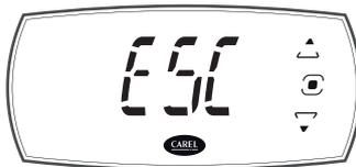
11. Lorsque les modifications sont terminées, dans les catégories sélectionner ESC et appuyer sur PRG pour quitter.
